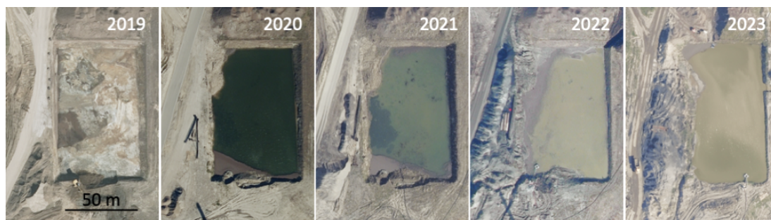
Figur 7. Udsnit af forårs-ortofoto fra 2019–2023, som viser bassinet nord for det bebyggede område. Fotoene viser, hvordan bassinet i løbet af perioden løftes op i dets vestlige side (tydeligst fra foråret 2022). På det sidste foto fra foråret 2023 har tåen af jordskredet bevæget sig ud i bassinet. Se Figur 4 for placering.
