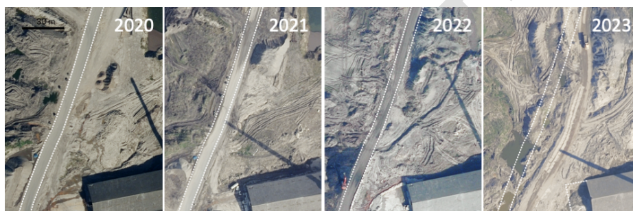
Figur 8: Udsnit af forårs-ortofoto fra 2020–2023, som viser forflytningen af en vej samt delvis nedrivning af lagerhal. De stiplede linjer viser forløbet af vejen i 2020 samt den oprindelige udstrækning af lagerhallen.
