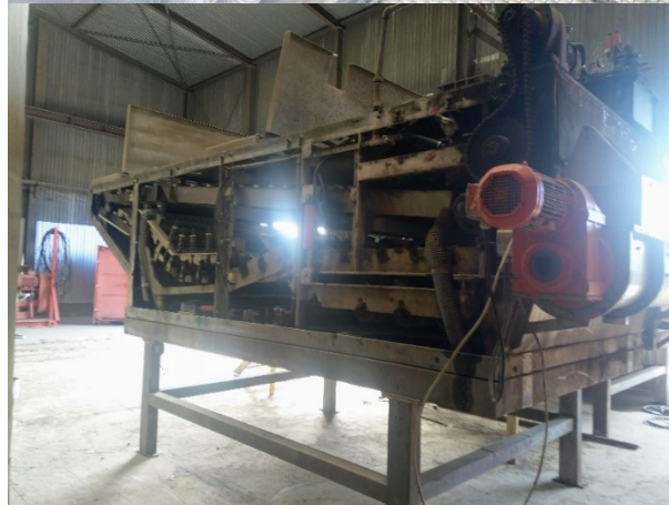
Figur 5: Illustration (ikke vores) og to billeder af vores sibåndspresse
