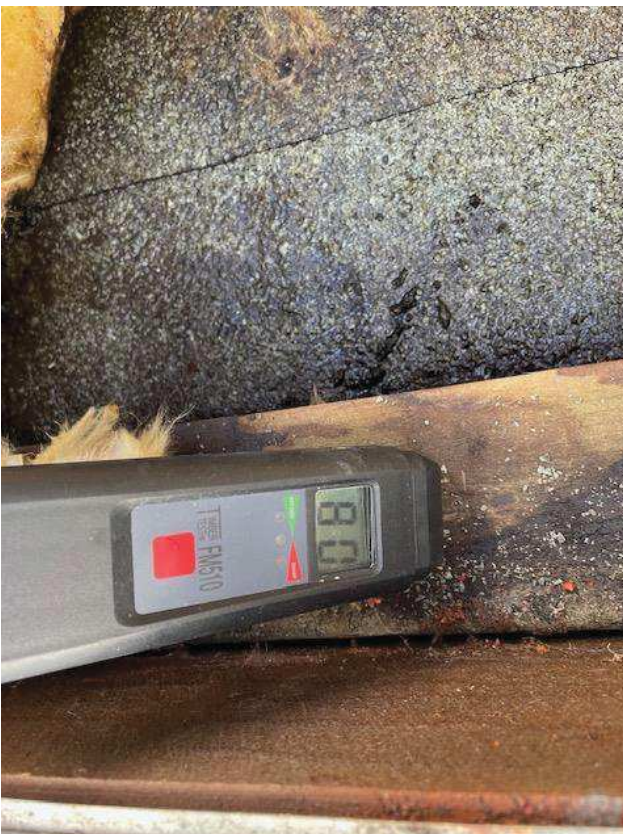
Foto nr. 6. Fugtprocenten i langsgående trælægte (50x75 mm) blev målt til 80 %.
