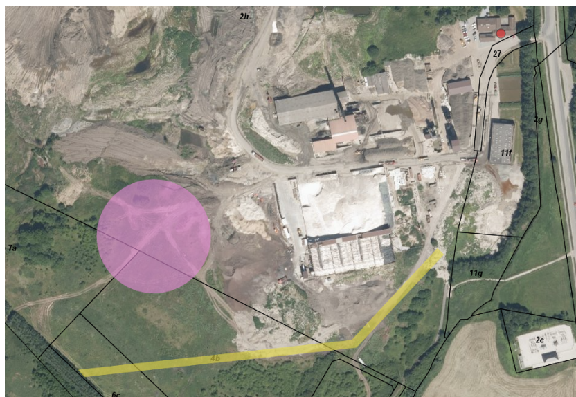
Figur 1: Princip for placering af jordvold vist med gul farve, og med lilla farve angivet princip for areal, hvorfra jord til etablering af volden hentes.
